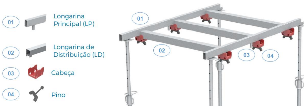
Figura 2 - Principais elementos do cimbramento
