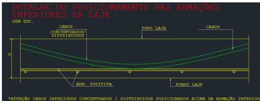
\*ATENÇÃO CABOS INFERIORES CONCENTRADOS / DISTRIBUIDOS POSICIONADOS ACIMA DA ARMAÇÃO INFERIOR.
