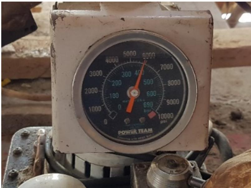
Figura 91: Manômetro marcando 400 Bar.
