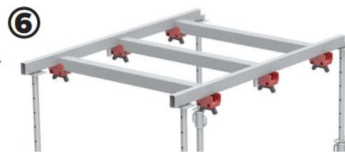
Dessa forma, as cargas providas pela laje sobre as fôrmas são transmitidas para as longarinas de distribuição, que por sua vez se apoiam e transmitem a carga para o sistema cabeça-pino e esse sistema, que está travado nas LPs, transmite os esforços para as longarinas principais e essas, por último, descarregam através das escoras para a laje de baixo.
